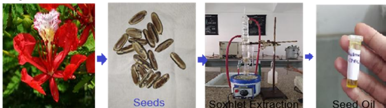
Fig 1: Soxhlet Extraction of Seeds of Delonix regia
